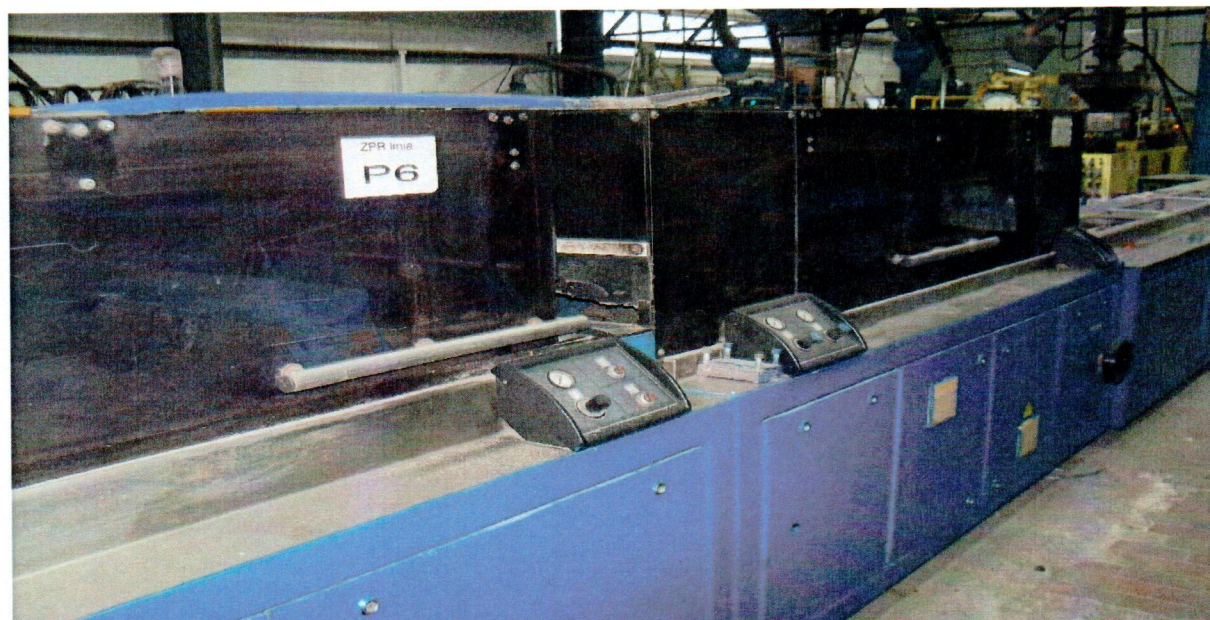
Fot.2 Zestaw odciąg-piła
