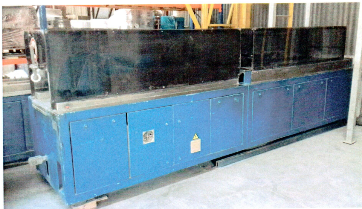
Fot.3 Zestaw odciąg-pila
