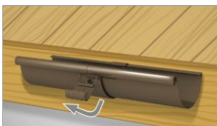
12a. Połączenie rynien uszczelnia się poprzez zamontowanie na zakładzie rynien złączki rynnowej. Złączkę należy zacześcić na tylnych krawędziach łączonych elementów, obrócić do góry.
