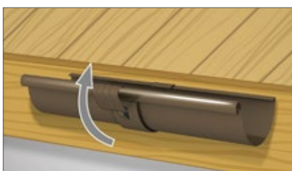
12b. Założyć klamrę na przednich wywinięciach łączonych elementów, odgiąć blaszkę zabezpieczającą.
