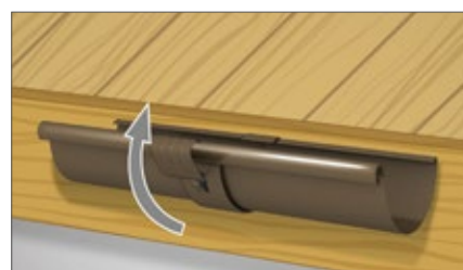
12c. Zatrzasnąć zatrask i zagiąć blaszkę zabezpieczającą.
