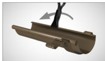
11d. Zaginamy odgięte wcześniej wywinięcie. Przed połączeniem rynien należy na zamontowaną rynnę wsunąć złączkę rynnową - jej założenie na połączone już rynny jest trudne.
