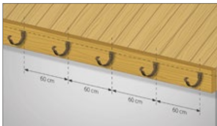
4. Za pomocą sznura traserskiego wyznaczamy linię spadku i montujemy uchwyty pośrednie (rozstaw ok. 60 cm). Uchwyty z obu stron narożnika montujemy na jednym poziomie.
