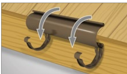
10. Montujemy rynny na uchwytach. Wkładamy tylne wywinięcie rynny w tylne wywinięcia uchwytnych, przekreślamy rynny w dół i zatraskujemy w uchwytnych.
