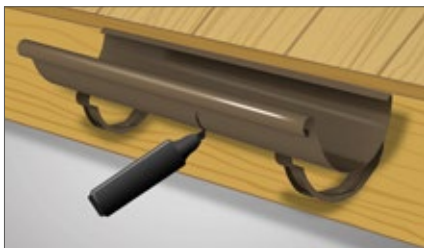
5. Umieszczamy rynnę na uchwytach i zaznaczamy na niej położenie leja spustowego.
